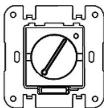
5.3.2. Ручку управления установите так, чтобы стрелка на ней была направлена на левый конец колбы встроенного датчика температуры (см.рисунок).
