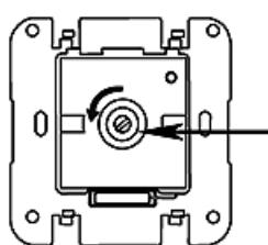
5.3.1. Если при установке термостата пришлось снять ручку управления, то для того, чтобы установить ее в правильное положение, шлицевой отверткой поверните ось реостата против часовой стрелки до щелчка.
