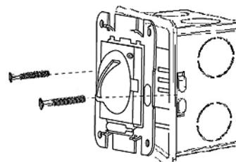
5.2.2. С помощью двух винтов присоедините термостат через декоративную тыльную рамку присоедините термостат к монтажной коробке.
